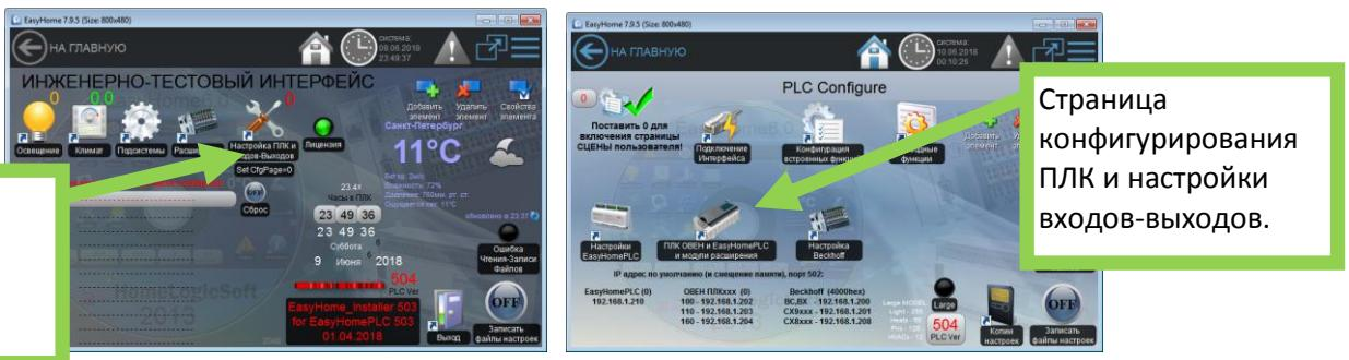
Выберите на главном окне программы страничку “**Настройка ПЛК и Входов-Выходов**”, затем “**ПЛК ОВЕН и модули расширения**” и откроется страница настройки драйвера модулей расширения (для его работы необходимо включить его на странице “**Менеджера портов RS232/485**”), здесь отображается имеющееся в контроллере количество входов выходов каждого из 4x типов DI, DO, AI, AO: .
