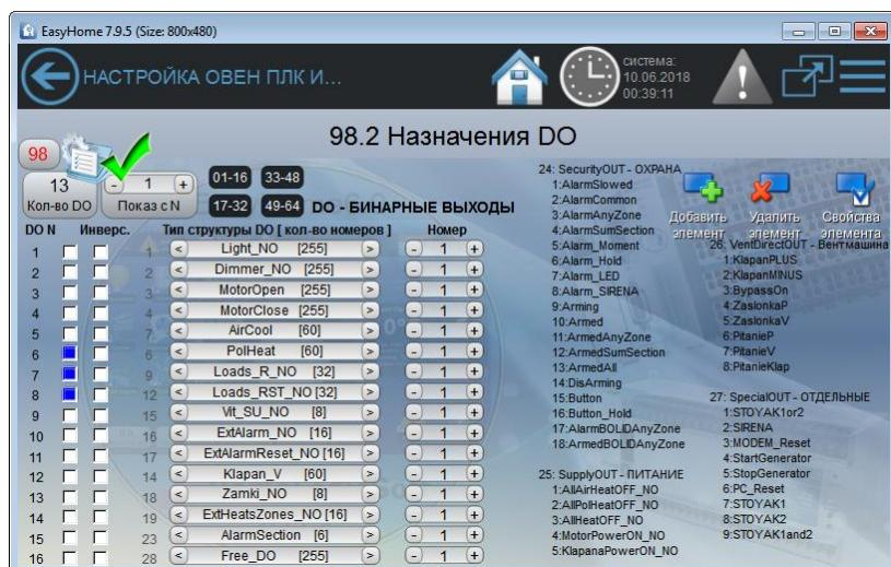
Если к бинарному выходу не назначена структура/массив и номер этой переменной, то можно управлять данным выходом вручную. ( Но при перезагрузке такое значение сбросится, если нужно ручное управление с памятью – используйте массив FreeDO, их значения в подсистеме свободных входов-выходов и функций сохраняются при сбое питания).
