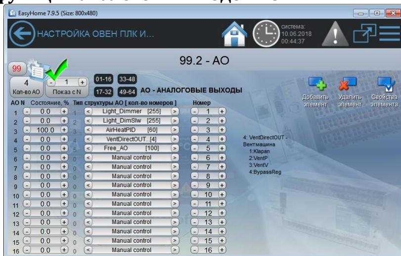
Если к аналоговому выходу не назначена структура/массив и номер этой переменной, то можно управлять данным выходом вручную. ( Но при перезагрузке такое значение сбросится, если нужно ручное управление с памятью – используйте массив FreeAO, их значения в подсистеме свободных входов-выходов и функций сохраняются при сбое питания).
