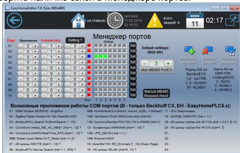
Необходимо выбрать Приложение порта N3 "ModbusRTU\_Search15" – программа поиска устройств отвечающих на базовый запрос функции x3 - чтения регистра в формате ModbusRTU с адресами 1..15. Требуется подождать ~ 50 секунд для проведения полного цикла поиска. Подробнее процесс визуализации поиска и найденных устройств можно увидеть на странице ручного запроса по данному порту:
