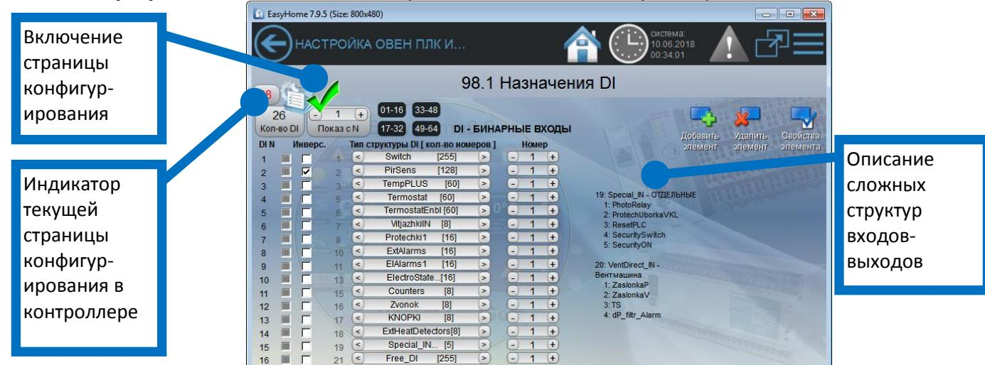
В графе **Кол-во DI** отображается доступное для данного контроллера и его модулей расширения количество входов. В таблице отображаются состояния и настройки 16ти входов, для контроллеров с количеством входов более 16ти предусмотрена общая прокрутка списка с помощью выбора **Показ с N**.
