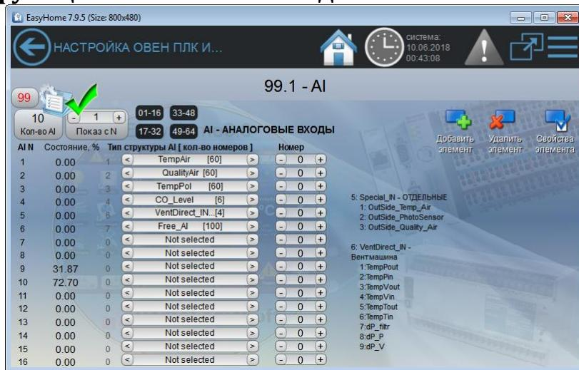
Аналоговые значения со входа контроллера 0..100% соответствуют физическому входному диапазону, обычно 0..10в. На данной странице они имеют внутреннее представление 0..32767, а в разные подсистемы преобразуются и визуализируются в соответствии с внутренними требованиями подсистем.
