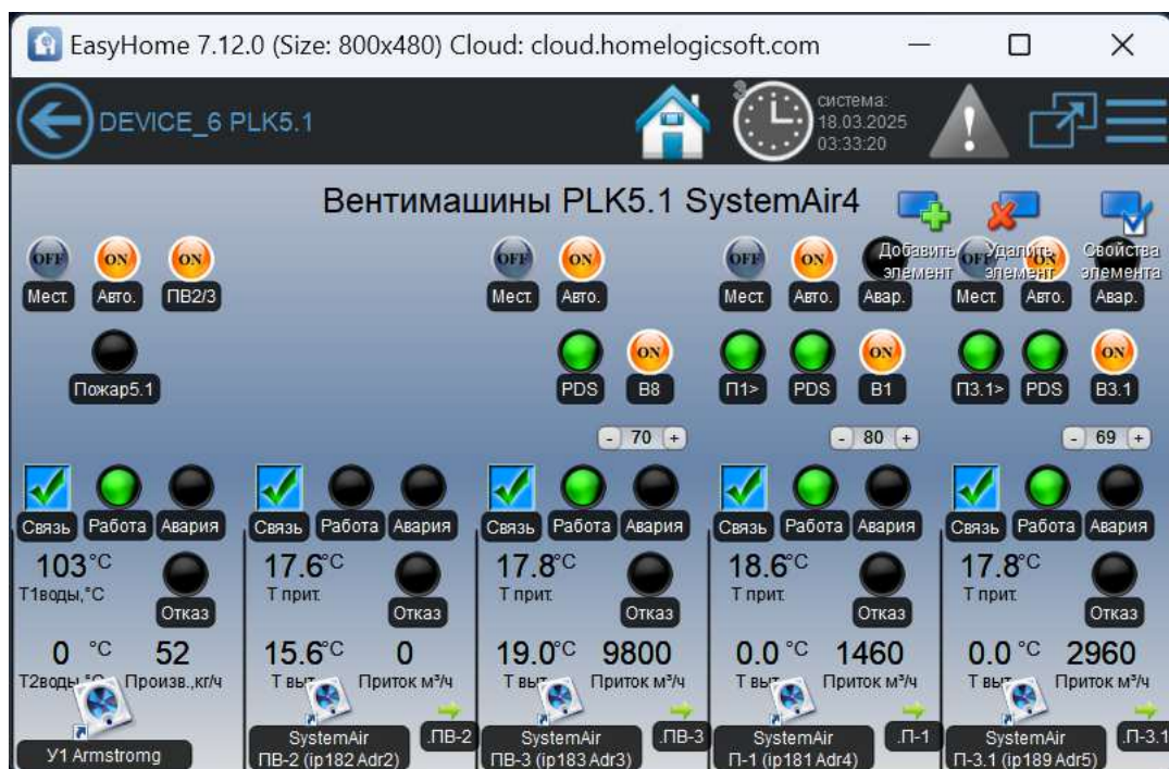
Рисунок 23 – Страница «Вентмашины ПВ-2, ПВ-3, П-1, П-3.1 и вытяжки В8, В1, В3.1, состояния ручек и сигналов запуска»
