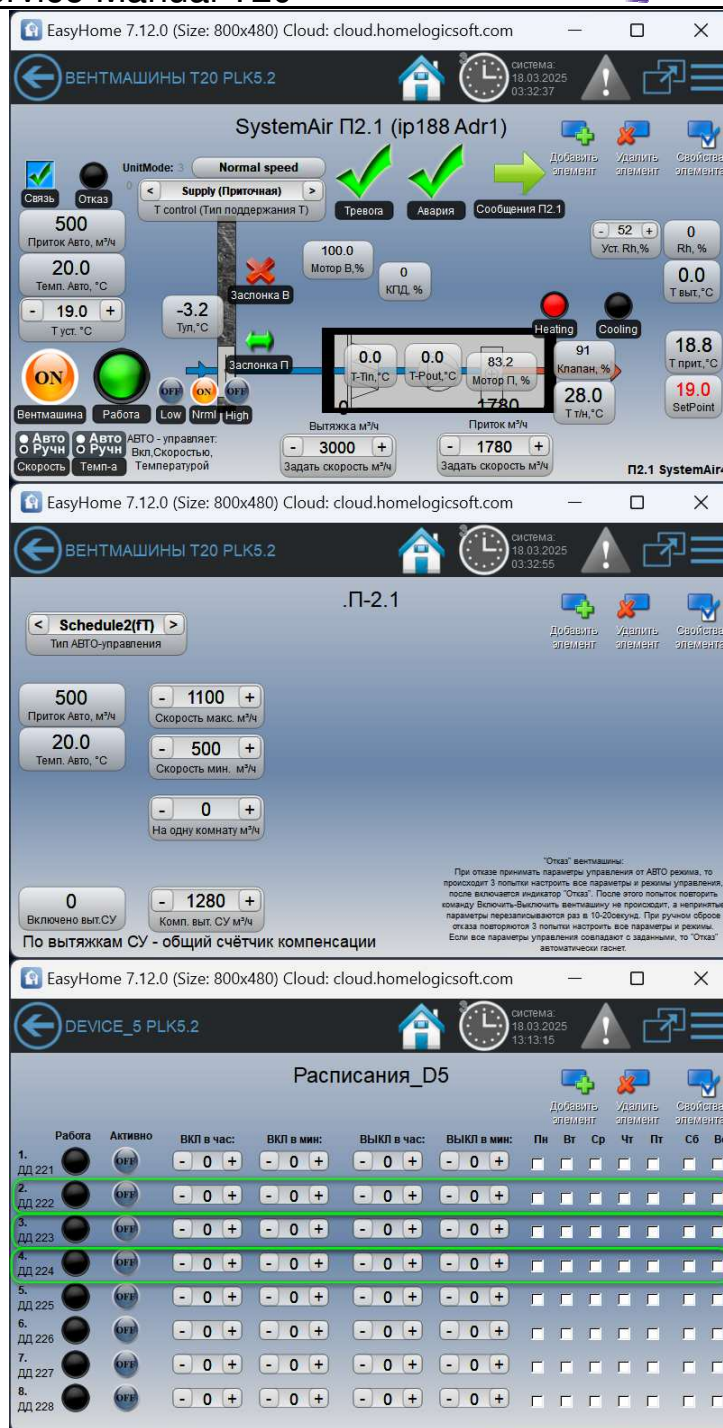
Рисунок 19 – Страницы «вентустановок П-2.1, П-4.1, ПВ-4 и настроек скорости и Расписания для функции АВТО Скорость »
