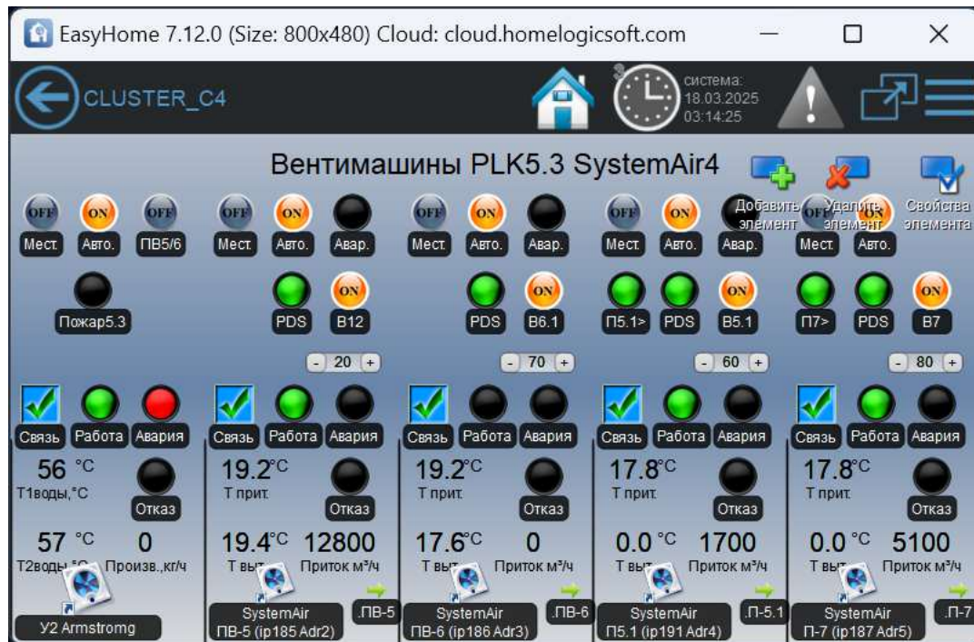
Рисунок 15 – Страница «Вентмашины PLK5.3 - ПВ-5, ПВ-6, П-5.1, П-7 и вытяжки B12, B6.1, B5.1, B7, состояния ручек и сигналов запуска»
