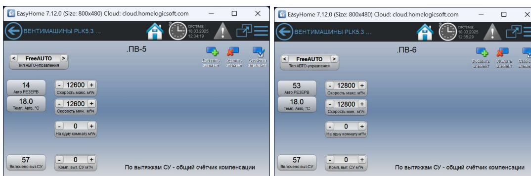
Рисунок 17 – Страницы «настройка скорости ПВ-5 и ПВ-6 для функции Авто Скорость совмещённой с функцией Авто РЕЗЕРВ»
