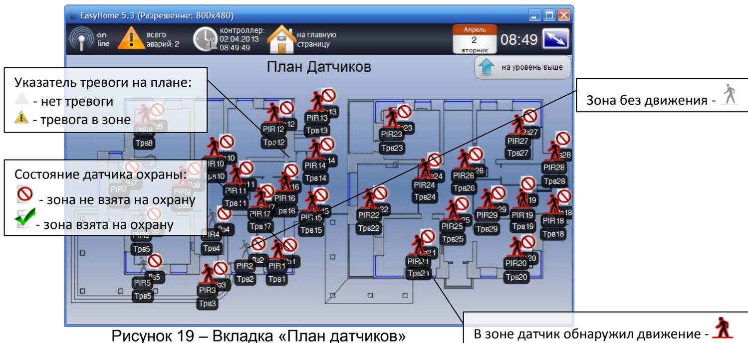
Рисунок 19 – Вкладка «План датчиков»
