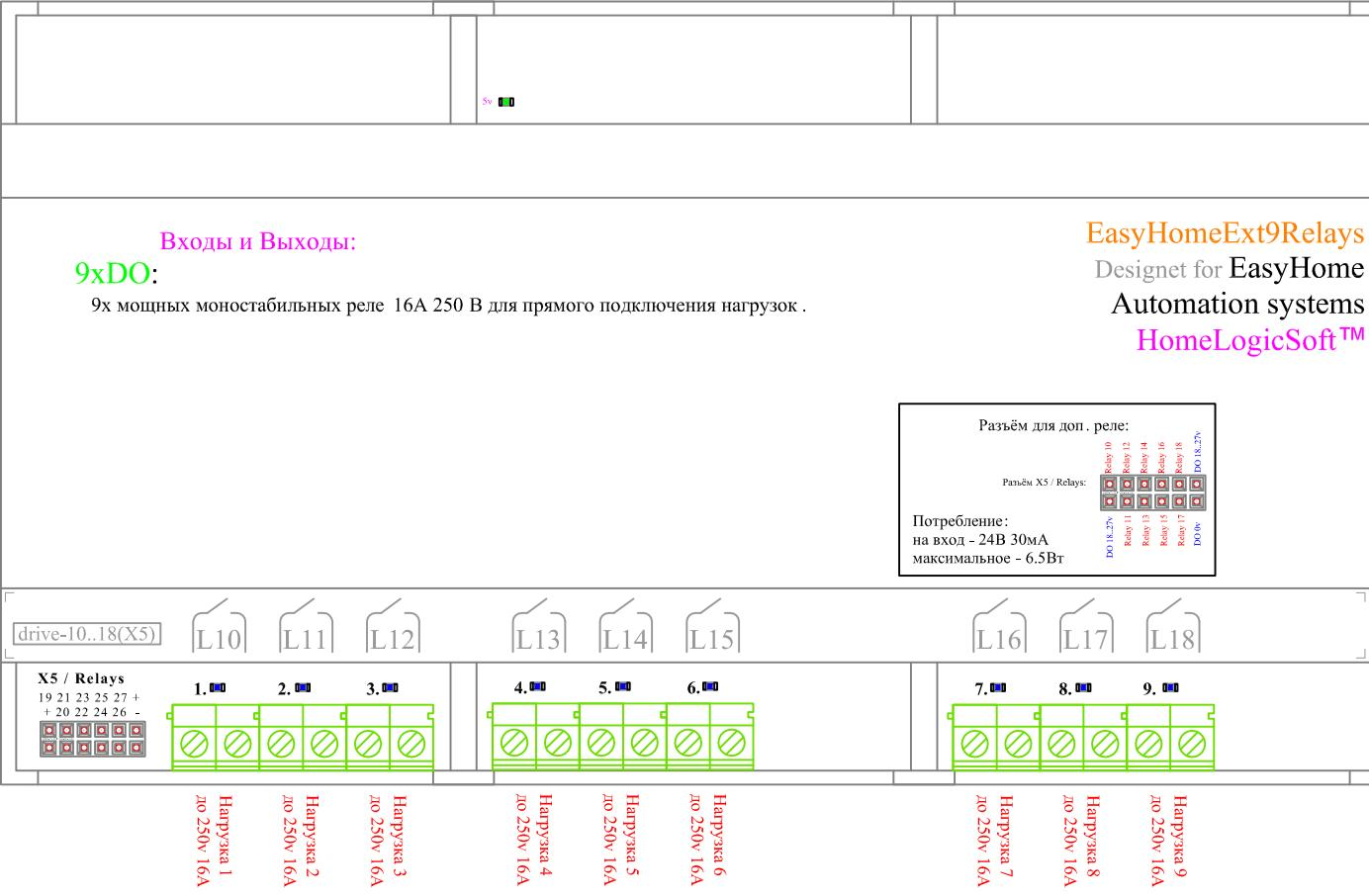
Встроенные реле управляются сигналом 24 В 20mA через разъём X5 от контроллера EasyHomePLC или от любого другого.
